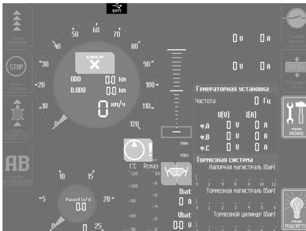
Рис. 7.9.1 – Основной экран АСКУМ с индикатором USB-флеш-накопителя
