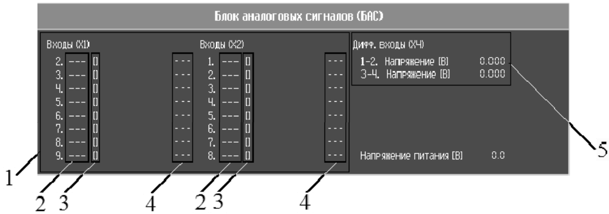
1 – секция аналоговых входов. Входы пронумерованы в соответствии с нумерацией контактов разъема; 2 – тип измеряемой величины. Здесь может быть “напряжение”, “ток”, “сопротивление”, “~напряжение”; 3 – единицы измерения величины. Здесь может быть “В”, “мА”, “Ом”; 4 – измеренная величина; 5 – секция дифференциальных входов.
