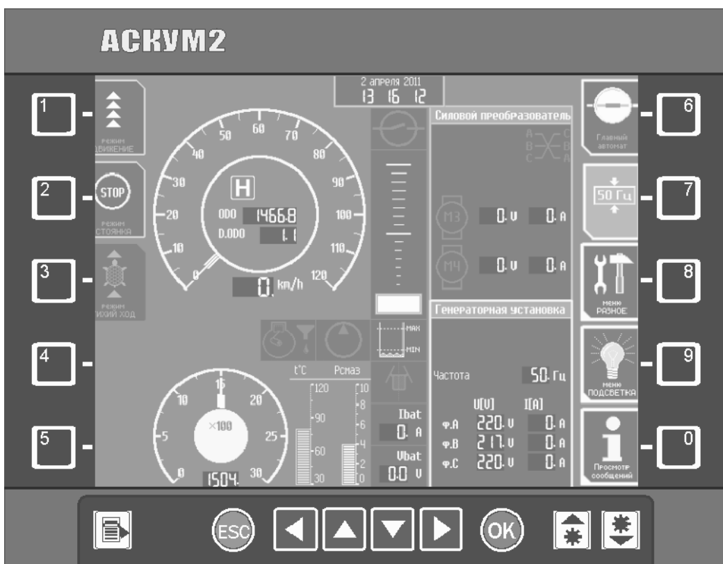
Рис. 7.1.1 – Монитор системы АСКУМ
